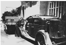
**L'essence** : est remplacée par le gazogène qui laisse derrière lui une odeur très désagréable et à l'intérieur du véhicule, une chaleur quasi insupportable. L'arrière du taxi Anzini, photographié
